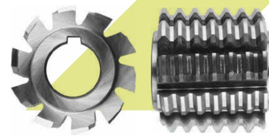
Обработка зубчатых и шлицевых соединений
