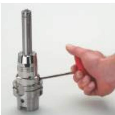
Затянуть зажимной винт гидравлического патрона до упора шестигранным ключом.
