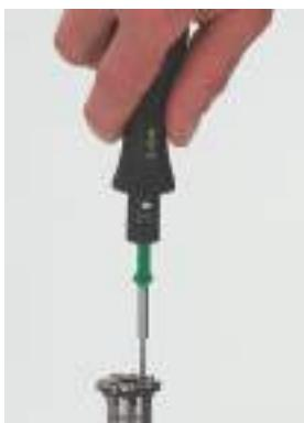
Затянуть зажимные винты крест-накрест динамометрической отверткой Торх.
