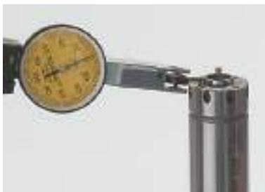
Отрегулировать биение с помощью четырех регулировочных винтов.
