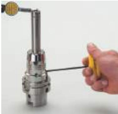
Повернуть четыре регулировочных винта с помощью ключа TORX PLUS® T15PQ до касания и измерить биение с помощью микронного индикатора врачаая патрон руками.
