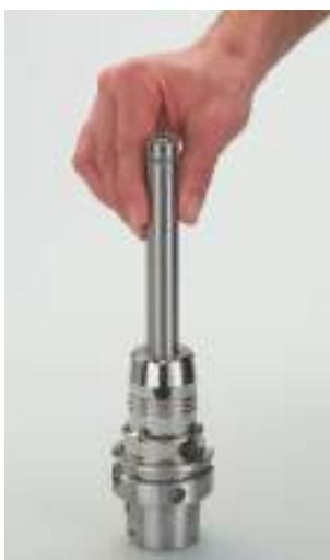
Вставьте державку для пластин непосредственно в гидравлический патрон или через переходную втулку до упора.
