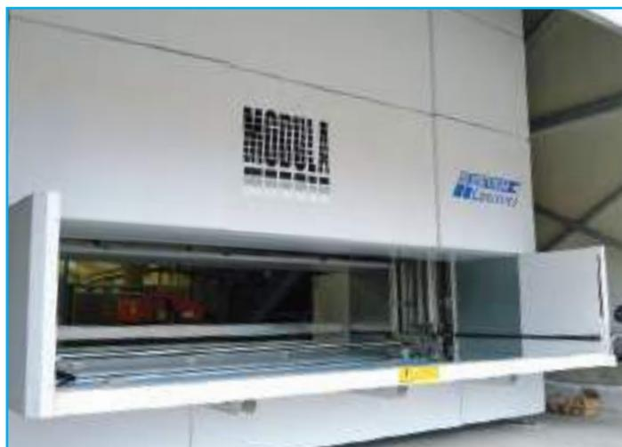
Gestione acciai con magazzino automatico verticale
