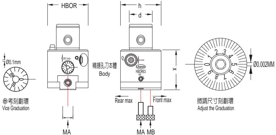
**HBOR 極細微調精搪孔刀-精搪孔刀本體**
