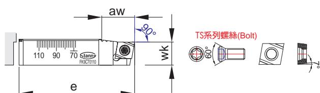
**HBOR 極細微調精搪孔刀-90°菱形精搪孔反搪刀座**
