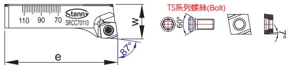
**HBOR 極細微調精搪孔刀-菱形精搪孔刀座**
